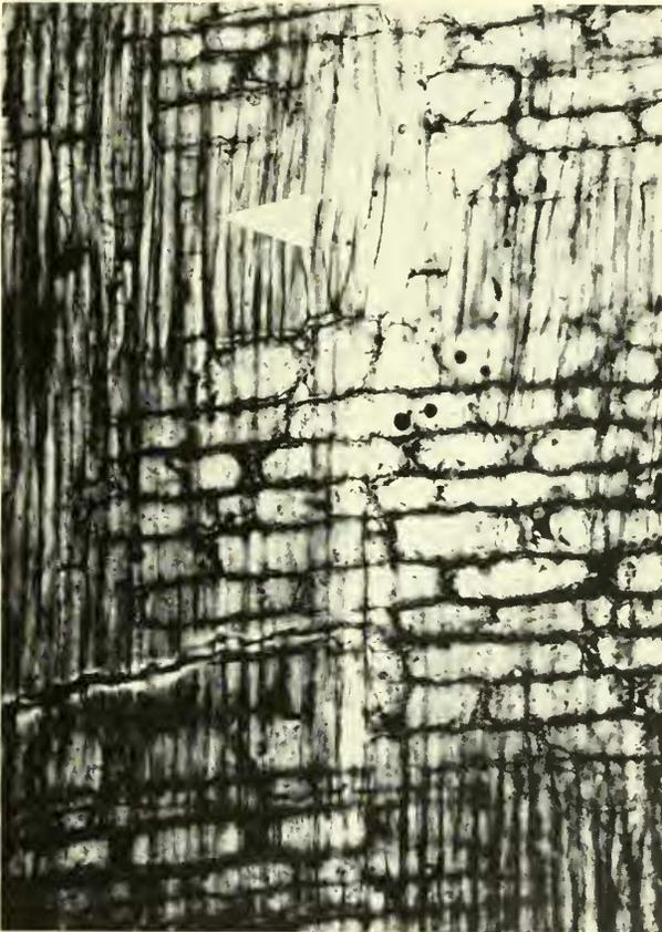
Abb. 3: Radialbild mit liegenden Holzstrahlzellen, Holzfasern und vertikalen Parenchymzellen (Pfeil). Schliff 1972 I 39 r; 180 x.
